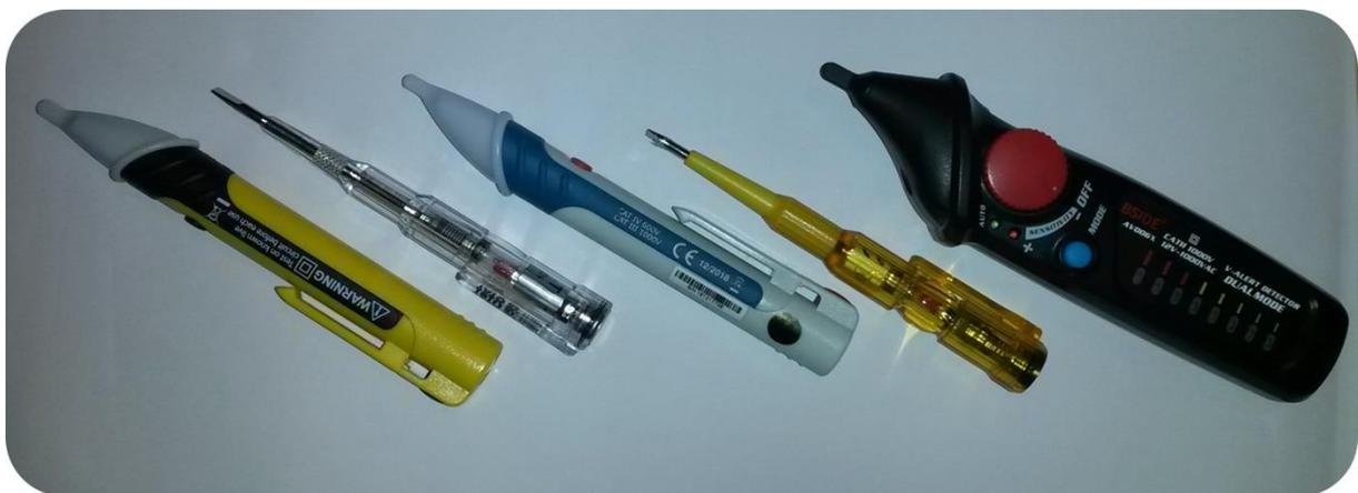
Diese Prüfer gibt es im Elektrofachhandel, Baumarkt oder im Internet ab ca. CHF 10 bis 35. Berührungslose Spannungsprüfer zeigen elektrische Wechselfelder in der Nähe von Kabeln an. Sie sind allerdings nicht dazu geeignet, elektrische Spannungsfreiheit sicher festzustellen.
