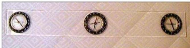
*Kompaßschiene auf einer Federkernmatratze: Deutliche Verzerrungen des Magnetfeldes*
